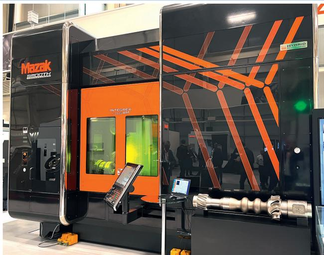
**3** Mazak kann auch hybrid: Lasergestützter Metallauftrag gefolgt von spanender Nachbearbeitung übernehmen unter anderem Multi-taskingmaschinen wie die Integrex i-300AM © Hanser
